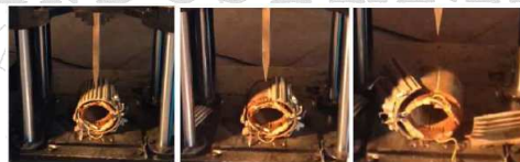
1º.- Corte de la carcasa exterior del motor (espesor < 5mm).
