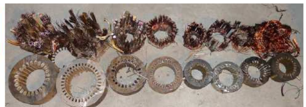
3º) Sistema de extracción del cobre del estator y resultado final.
