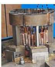
3º) Sistema de extracción del cobre del estator y resultado final.
