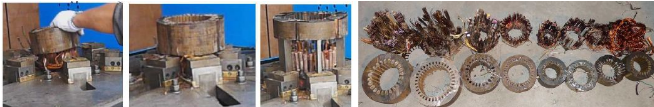
3º) Sistema de extracción del cobre del estator y resultado final.
