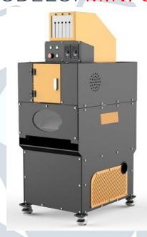
Equipo compacto con mesa de separación en seco, para reciclaje de cables de entre 0,5 y 12 milímetros de diámetro exterior.
