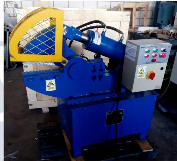
Cizallas hidráulicas tipo cocodrilo, para el corte de chatarra ligera, perfilería de aluminio, cables, radiadores, etc...
