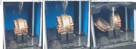
2º.- Corte del estator por la mitad (diámetros entre 8 y 25 cm).
