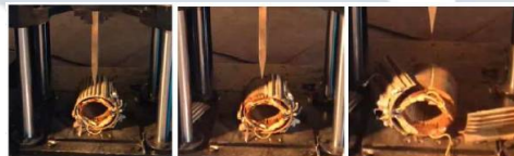
1º.- Corte de la carcasa exterior del motor (espesor < 5mm).
